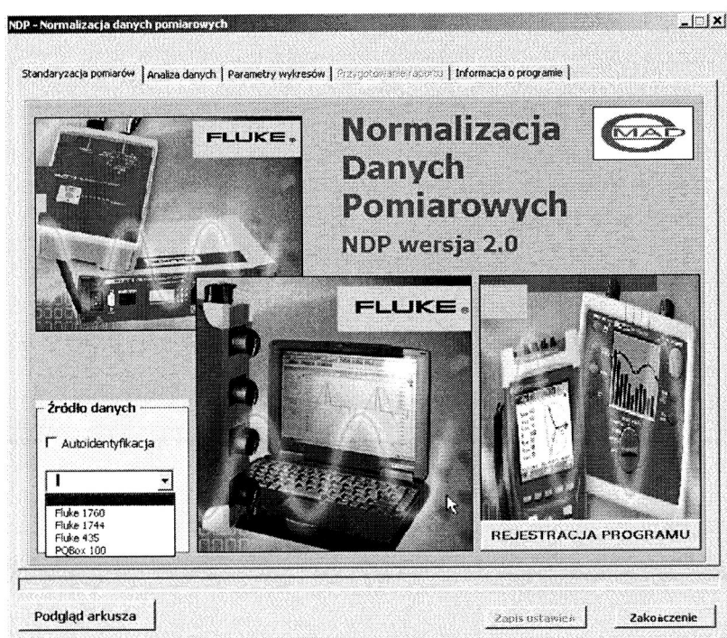
Rys. 7.4. Interfejs użytkownika programu NDP – import danych zarejestrowanych przez mierniki jakości energii
