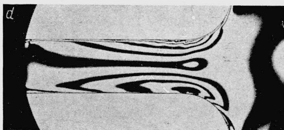
Rys. 36. Przebieg izochrom w przecie zginanym siłą skupioną (wszystkie pręty wykonane na wycinarce, rys. 7)
