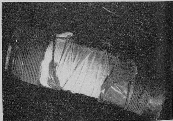
Rys. 7. Przykład rozerwania uzwojenia wtórnego w transformatorze prądowym suchym talerzowym przez siły osiowe ściskające
