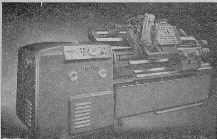
Rys. 8. Tokarka kopiarka f-my Magdeburg. Największa średnica wydajnie obrabiana 125 mm — długość toczenia 1250 lub 1600 mm, zakres obrotów 140–2240 obr/min, moc silnika 15 kW.
