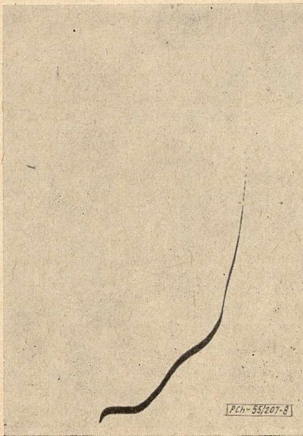
Rys. 8. Jak na rys. 7, jednak roztwór rozcieńczony trzykrotnie roztw. podstawowym, fala nitrometanu zdjęta z czułością 1/3
