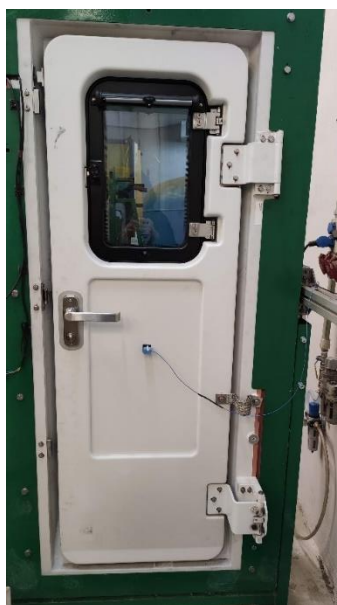
Rys. 4. Wewnętrzna strona stanowiska testowego z umocowanym czujnikiem przyspieszenia na środku skrzydła drzwi
