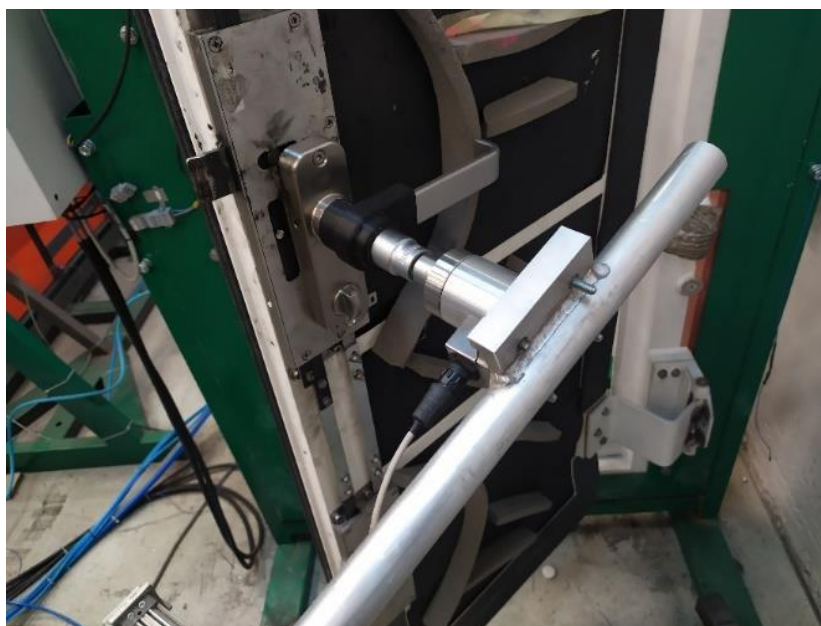
Rys. 8. Pomiar momentu obrotowego potrzebnego do obsługi uchwytu
