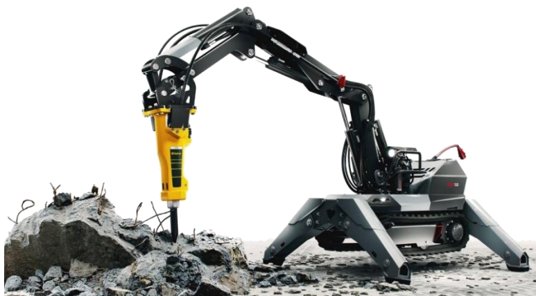
Rys. 1. Zdalnie sterowany robot wyburzeniowy ARE 1.0 firmy ARE sp. z o.o. wykorzystany do badań [1]
