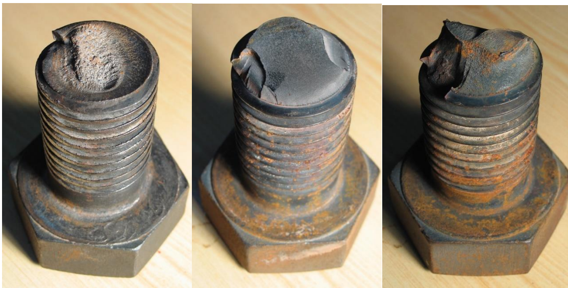
Rys. 2. Przykłady zerwanych śrub mocujących wirnik podgrzewacza powietrza
