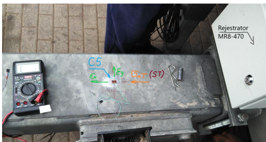
Rys. 6. Punkt pomiarowy C5 na górnej półce dyszla
