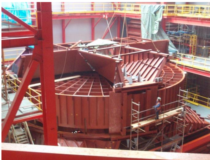
Rys. 1. Przykładowy układ konstrukcyjny obrotowego podgrzewacza powietrza
