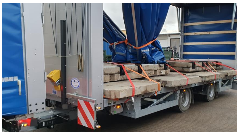
Rys. 8. Przyczepa centralnoosiowa przygotowana do pomiarów
