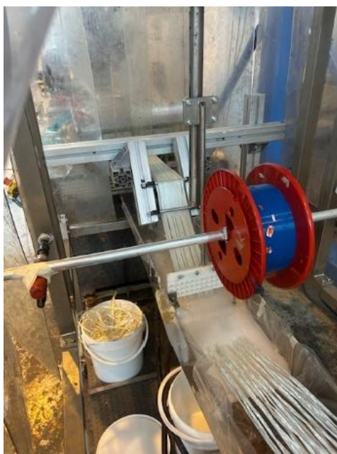
Rys. 11. Proces integracji zbrojenia z włóknem światłowody
