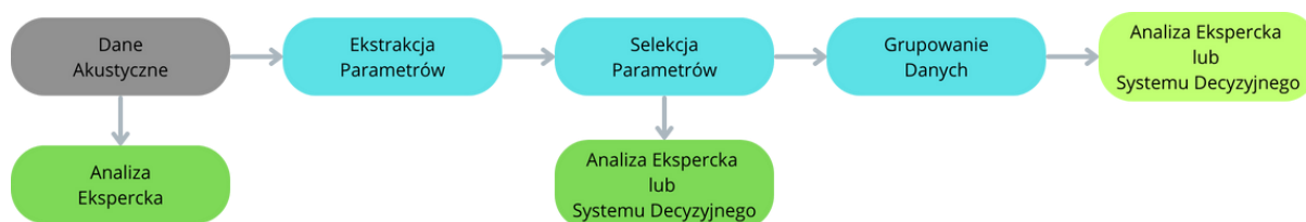
Rys. 1. Przykładowy proces analizy danych akustycznych przy użyciu metod ML
