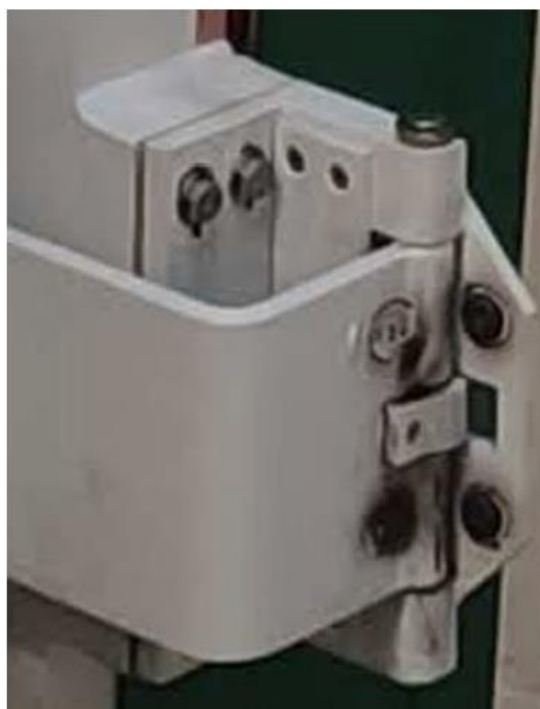
Rys. 7. Delikatne odcisnięcie dolnych zderzaków zawiasu na łapie zawiasu
