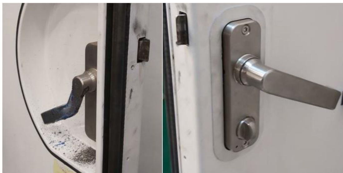
Rys. 5. Brak automatycznego powrotu uchwyty do pozycji wyjściowej przy 226 200 cyklach
