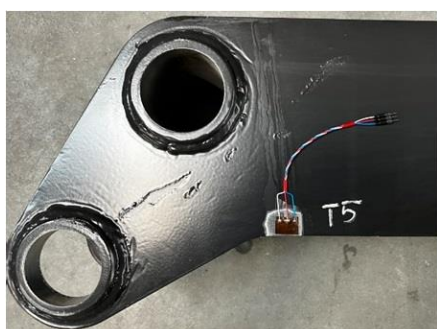
Rys. 11. Przykładowe miejsce rozmieszczenia tensometrów i czujników przyspieszeń w wybranych punktach konstrukcji nośnej robota, wytypowanych na podstawie wyników analizy MES oraz przykładowy przebieg przyspieszenia w czasie dla wybranego punktu konstrukcji robota – kucie materiału
