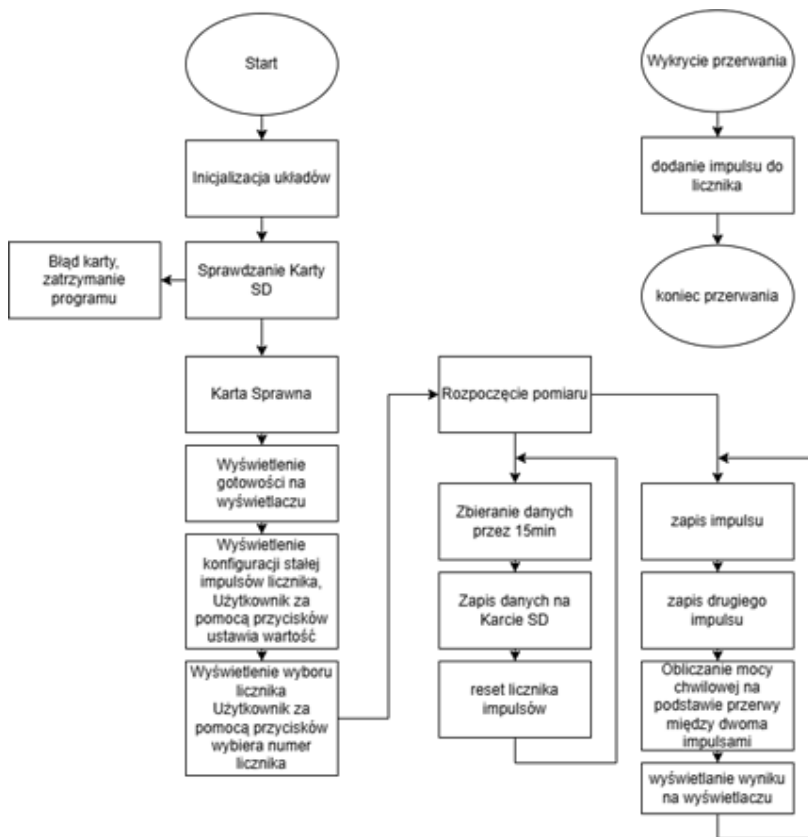
Rysunek 12.3. Schemat blokowy programu zaimplementowanego w module Arduino
