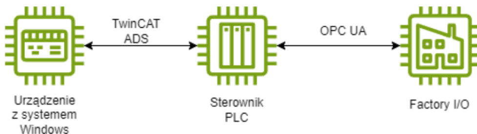
Rysunek 20.1. Schemat połączenia wszystkich komponentów
