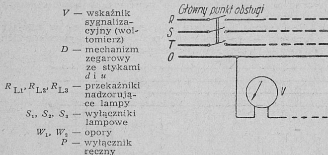
Rys. 15. Schemat automatycznie sterowanego punktu włączania w sieci oświetleniowej z własnym zasilaniem
