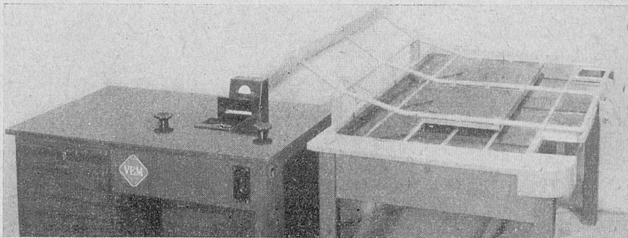
Rys. 3. Widok ogólny urządzenia do klasyfikacji blach
