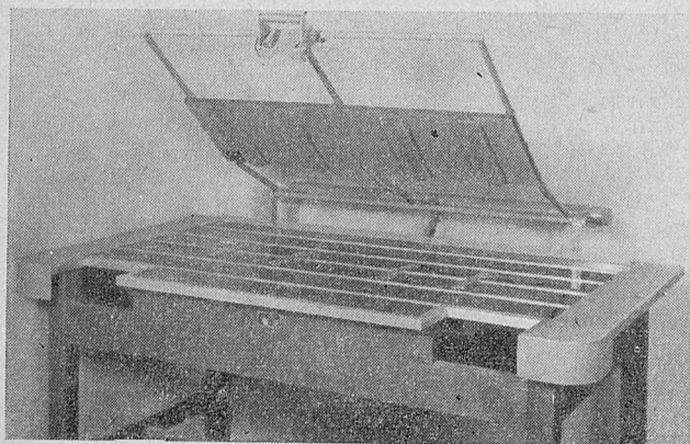
Rys. 1. Stół probierczy — rama dociskowa podniesiona
