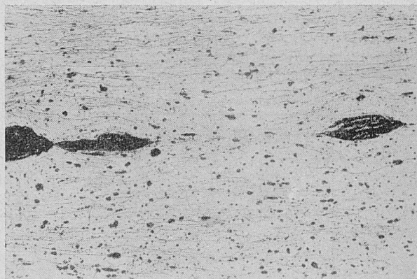
Rys. 5. Mikrostruktura spoiny otrzymanej przez spajanie na zimno (powiększ. ∞ 100-krotnie)
