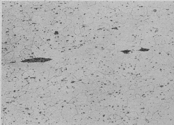
Rys. 6. Mikrostruktura tego samego miejsca spoiny po wyżarzeniu przy temperaturze 420°C przez 1 godz. (powiększ. ∞ 100-krotnie)
