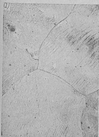
Rys. 23. Mikrostruktura brązów krzemowych: a) struktura \alpha , CuSi3, trawiono \text{FeCl}_3 , pow. 500X; b) — struktura \alpha + (\alpha + \gamma) , CuSi3,8, trawiono \text{FeCl}_3 , pow. 100X; c) — struktura \alpha + \gamma , CuSi4,5, trawiono \text{FeCl}_3 , pow. 100X.
