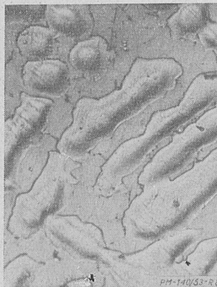
Rys. 8. Mikrostruktura mosiądzu α (MK80), odlew piaskowy. Charakterystyczne dendryty roztworu stałego. Trawiono elektrolitycznie, pow. 100×.
