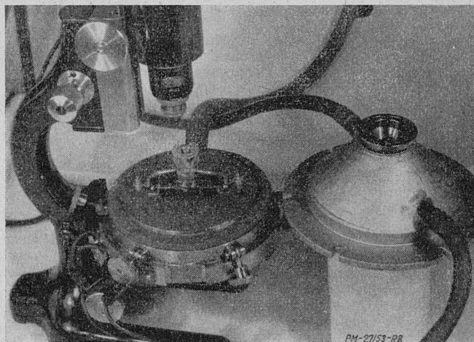
Rys. 8. Otwarty piecyk próżniowy spoczywający na stoliku przedmiotowym mikroskopu.
