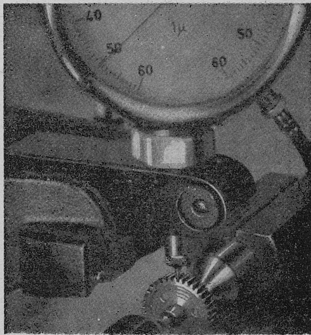
Widok przyrządu do pomiaru „bicia” mikrozębień z dokładnością do 1\mu
