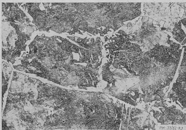
Rys. 3. Stal ok. 0,4% C i 1,5% Mn — ziarno austenitu ujawnione metodą siatki ferrytu. Trawienie w 2% roztworze alkoh. kwasu azotowego (pow. \times 100 ).
