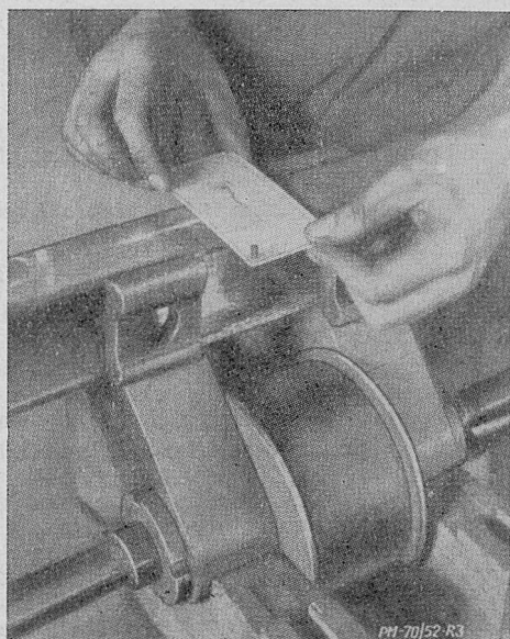
Rys. 3. Przyrząd magnetyczny z nakładkami do ujawniania rys.
