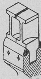
Rys. 8. Łopatkka przyspawana do tarczy wirnikowej.
