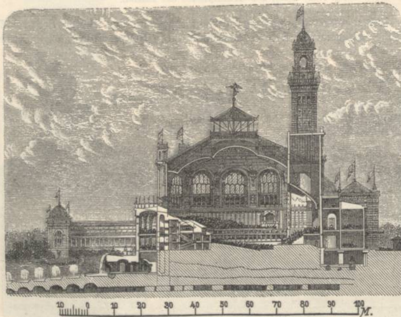
Fig. 1148. Trocadéro-Palast. Durchschnitt nach der Hauptaxe (Architekten Davioud & Bourdais).
