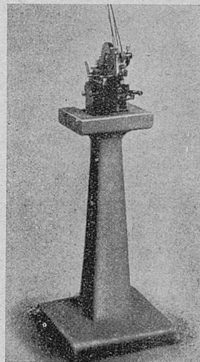
Rys. 4. Szlifierka do frezów na podstawie betonowej.
