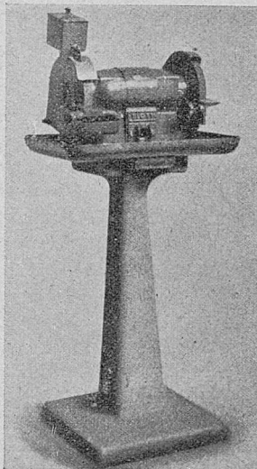
Rys. 3. Szlifierka do narzędzi na podstawie betonowej.
