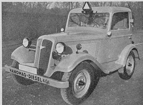
Rys. 35. Mały ciągnik szosowy z silnikiem o mocy 20 KM w wykonaniu firmy „Hanomag”.
