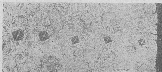
Rys. 8. Pomiar mikrotwardości warstwy nawęglanej. Obciążenie 100 G. Pow. 350 \times (wg E. B. Bergsmanna).
