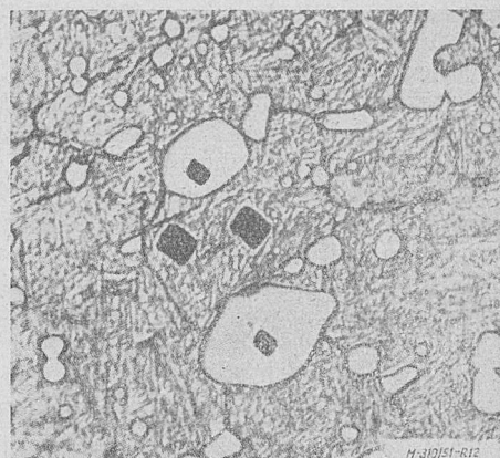
Rys. 12. Pomiar mikrotwardości składników strukturalnych stali szybkoctnej. Obciążenie 10 G. Pow. 1500 x (wg E. B. Bergsmanna).
