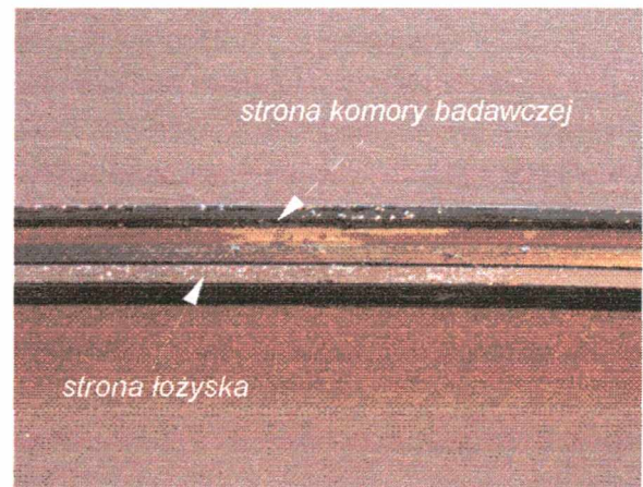
Rys. 7.34 Widok na zewnętrzny pierścień gumowy- niewielka ilość piasku od strony komory
