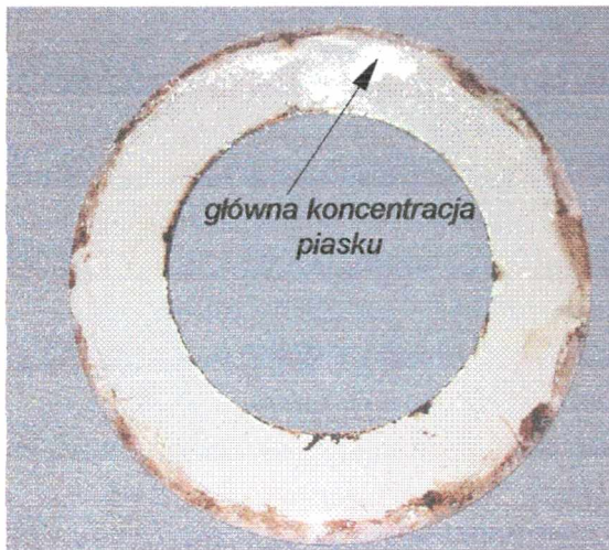
Rys. 7.31 Widok zewnętrznej nieruchomej blaszki po badaniach w atmosferze zapyłonej
