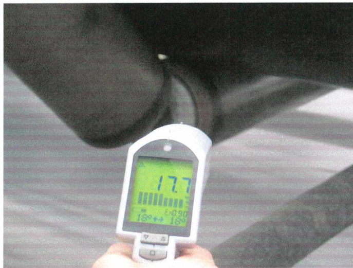
Rys.5.2 Terenowy pomiar temperatury pirometrem TPT 62
