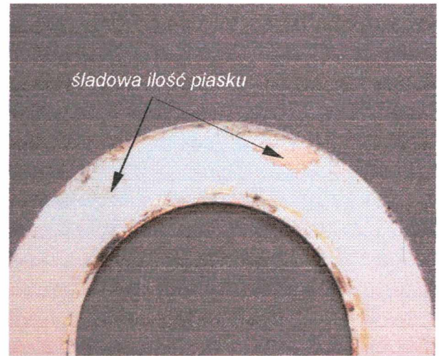
Rys. 7.32 Widok wewnętrznej nieruchomej blaszki po badaniach w atmosferze zapyłonej
