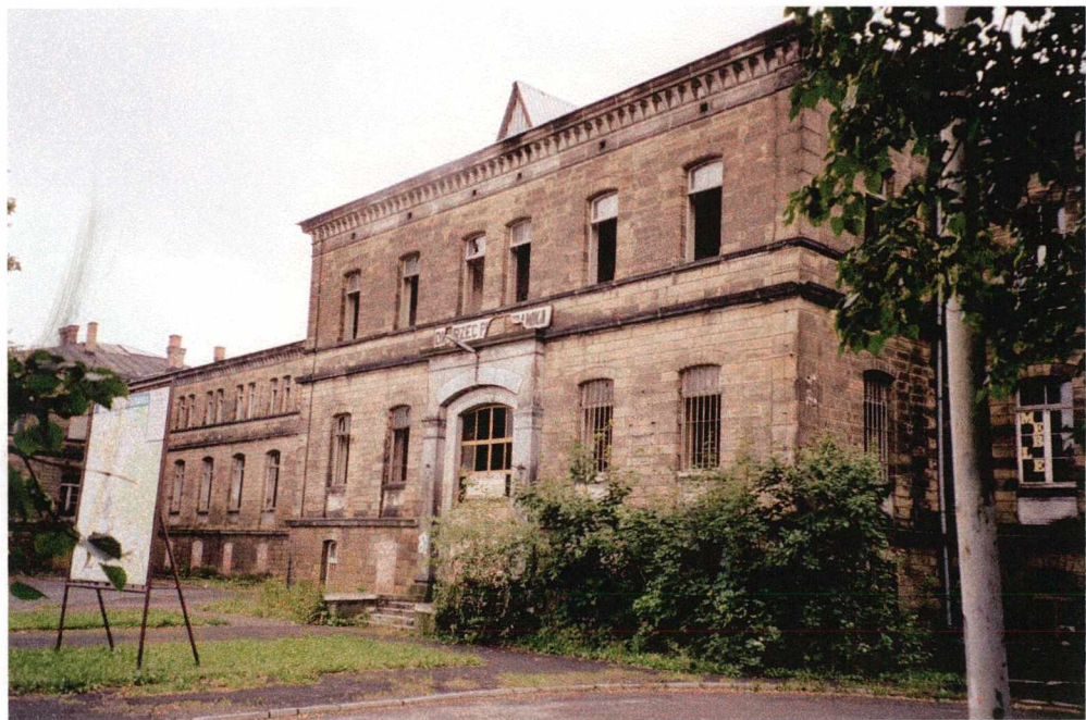
Fot. 94 Lubawka. Duży dworzec graniczny (część wejściowa od strony podjazdu). Monumentalny charakter budowli oprócz jej wymiarów podkreśla materiał na elewacjach (piaskowiec) oraz klasycyzujące detale: gzymsy i portale
