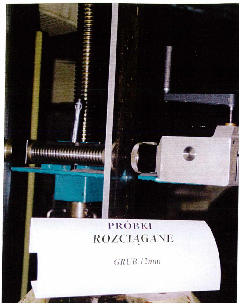
5.5. Pomiar twardości przy rozciąganiu próbek grubości 12 mm
