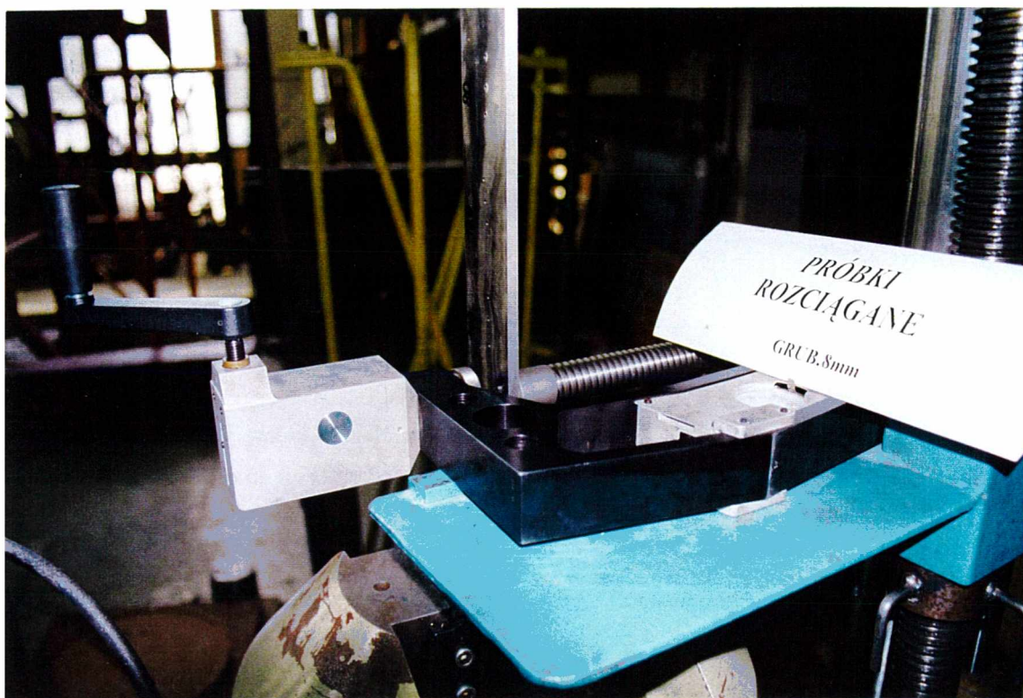
Rys. 5.7. Położenie twardościomierza na stoliku podczas pomiaru twardości
