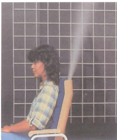
Rys. 24. Wpływ powietrza z oparcia fotela wyposażonego w nawiewnik typu DJ [KRANTZ]
