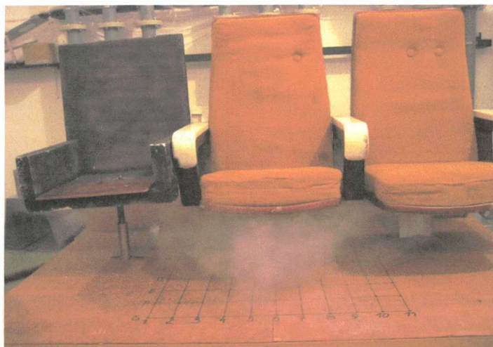
Rys. 86. Widok z przodu na siatkę pomiarową. Układ powierzchni: Z-010-60 / W-06-30_18. Strumień powietrza nawiewanego V = 45 \text{ m}^3/\text{h}
