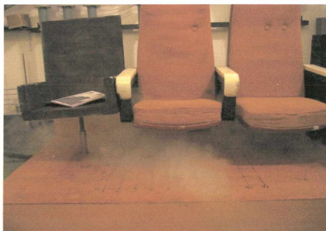
Rys. 84. Widok z przodu na siatkę pomiarową. Układ powierzchni: Z-06-40 / W-06-30. Strumień powietrza nawiewanego V = 45 \text{ m}^3/\text{h}
