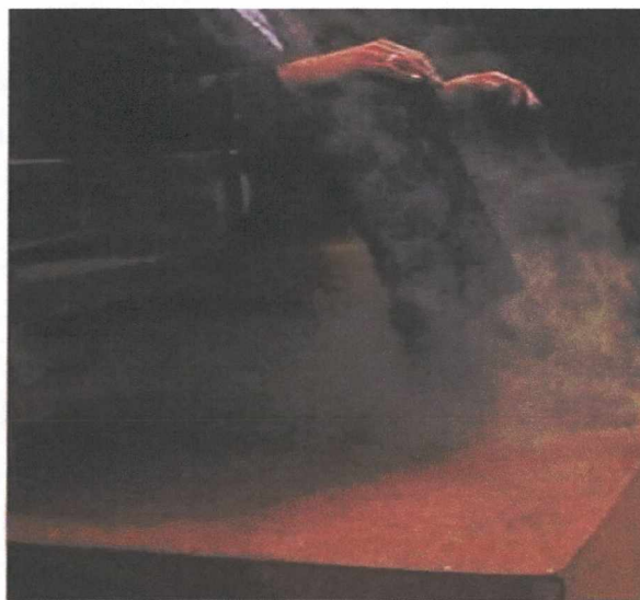
Rys. 90. Nawiew powietrza na: fotel wolny (A) oraz fotel zajęty przez człowieka (B). Układ powierzchni: Z-06-40 / W-06-30_18. Strumień powietrza nawiewanego V = 45 \text{ m}^3/\text{h} .
