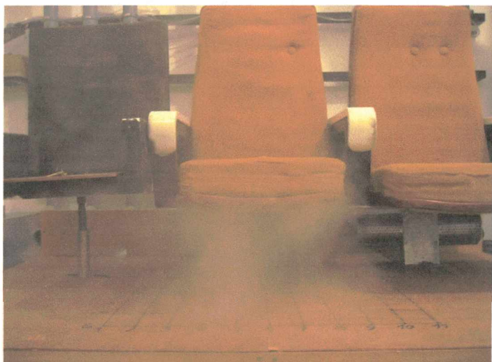
Rys. 88. Widok z przodu. Układ powierzchni: Z-010-60 / W-06-30S. Strumień powietrza nawiewanego V = 45 \text{ m}^3/\text{h} .
