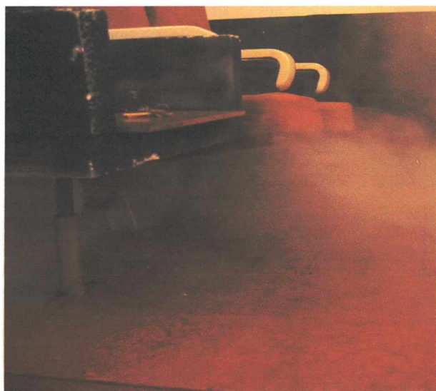
Rys. 90. Nawiew powietrza na: fotel wolny (A) oraz fotel zajęty przez człowieka (B). Układ powierzchni: Z-06-40 / W-06-30_18. Strumień powietrza nawiewanego V = 45 \text{ m}^3/\text{h} .
