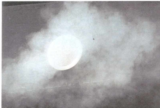
Rys. 32. Wypływ z nawiewnika Q-SR oraz jego konstrukcja [KRANTZ]
