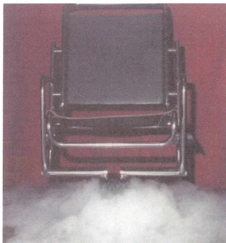
Rys. 55. Wypływ powietrza z nawiewnika fotelowego stopowego typu Q – ST [KRANTZ]
