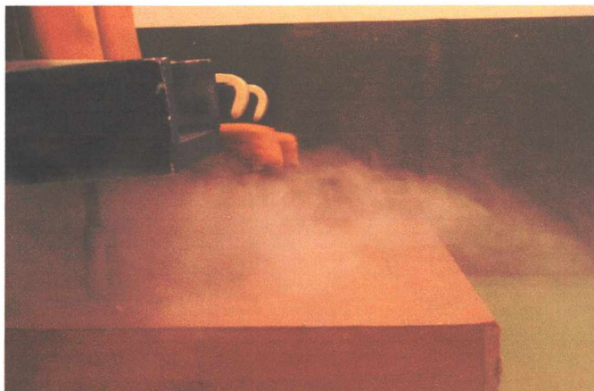
Rys. 89. Widok z boku. Układ powierzchni: Z-010-60 / W-06-30S. Strumień powietrza nawiewanego V = 45 \text{ m}^3/\text{h} .
