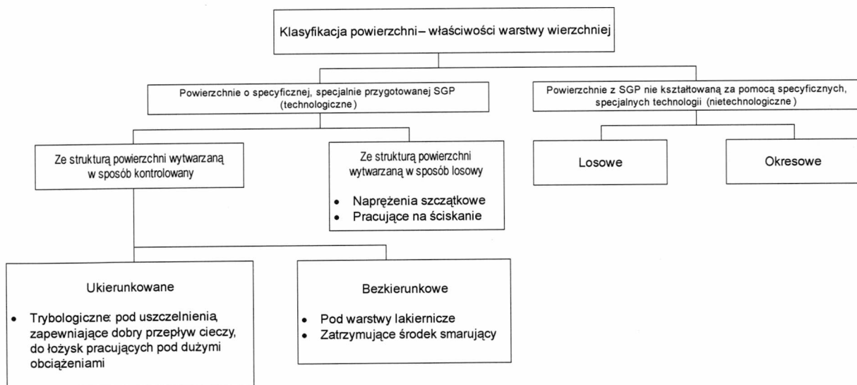
Rys.3.4. Klasyfikacja powierzchni ze względu na otrzymane właściwości warstwy wierzchniej [94]
