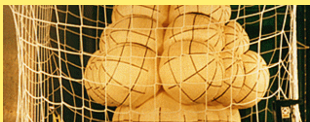
Rys. 2.10 2) – poduszki pneumatyczne z Vectranu, wykorzystywane podczas lądowania sondy Pathfinder na powierzchni Marsa w lipcu 1997 r.
