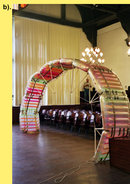
Rys. 5.76 – wypiętrzanie modelu M-4: a). widok modelu przed wypiętrzaniem b). widok boczny modelu po wypiętrzaniu c). widok „przegubu”, powstałego po wypiętrzaniu d). widok frontowy modelu po wypiętrzaniu e). widok modelu po obciążeniu siłą Q = 0.03 \text{ kN}
