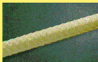
Tablica 2.81 – Charakterystyka lin z włókien węglowych, CFCC, produkowanych przez firmę Tokyo Rope (Japonia), wg [5.23] [5584]
