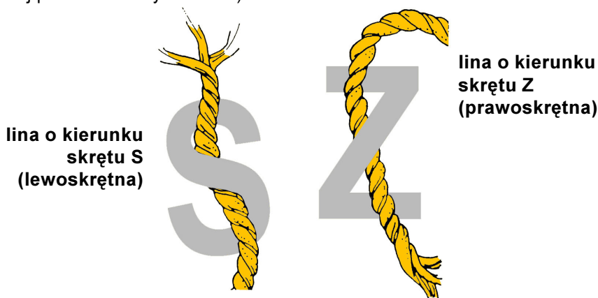
Rys. 2.41 – kierunki skrętu lin włókiennych; na podstawie [94]
