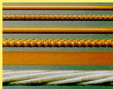
Rys. 2.127 – widok przykładowych cięgien Technora, wg [121]
