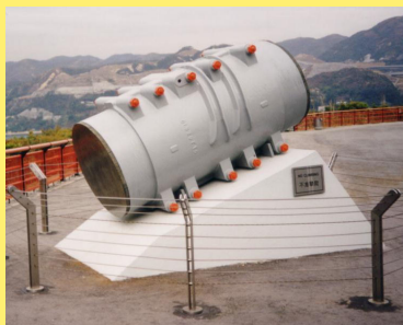
a). widok fragmentu liny kablowej
