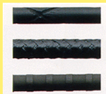
Rys. 2.124 – widok przykładowych prętów Leadline, firmy Mitsubishi Kaisei, wg [121]
