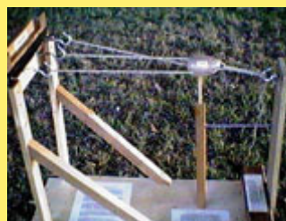
Rys. 2.48 – prosty model ilustrujący zasadę wykonywania lin na „ścieżce linowej” [153]
