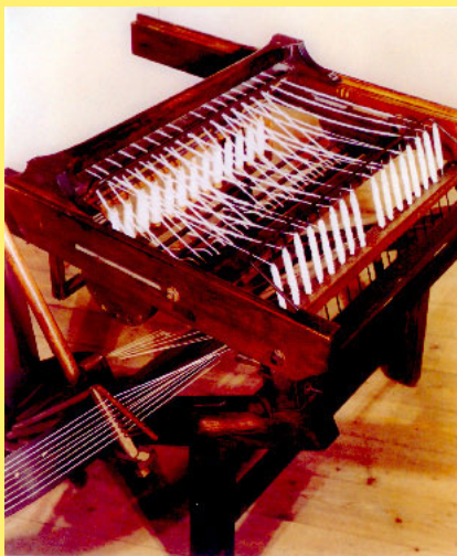
Rys. 2.176 – „Spinning Jenny” – jeden z pierwszych egzemplarzy przędzarki skonstruowanej przez Jamesa Hargreavesa w 1763 r. Maszyna, pochodząca z 1770 r., znajduje się w Quarrybank Mill, w Styal, w Wielkiej Brytanii. Ilustracja za [29]
