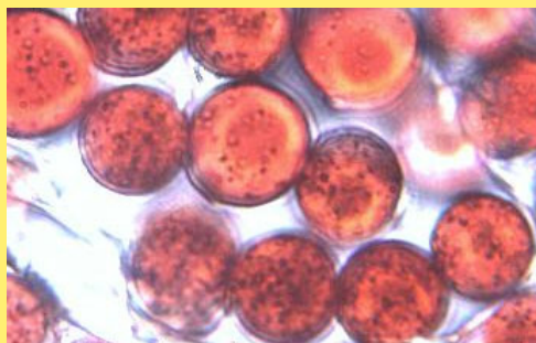
Rys. 2.8 – przekrój włókien poliestrowych, powiększenie 1 000 x. Włókna półmatowe, barwione dwutlenkiem tytanu. Fotografia: Tae Woo Kim, FITI Testing & Research Institute, Korea za [233]
