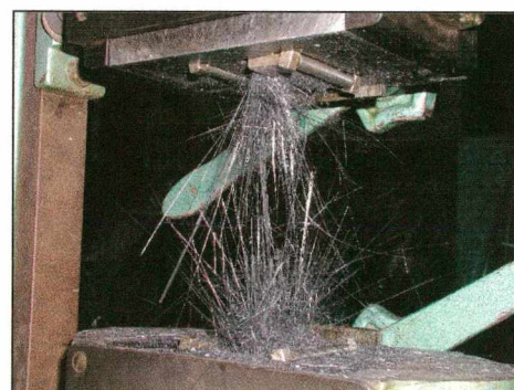
b) próbka po zniszczeniu
