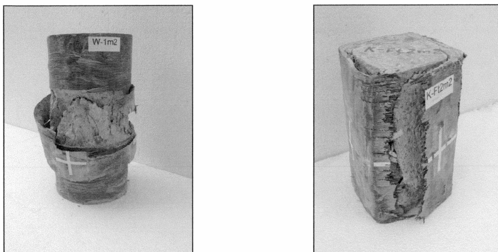
Rys. 2.11. Próbkę W-1m2 i K-Ft2m2 po zniszczeniu [14]
