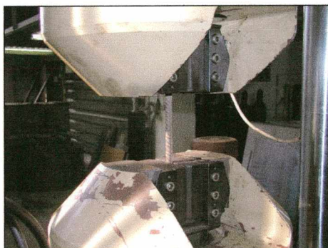
Rys. 4.61. Określenie granicy plastyczności prętów \varnothing 12 mm (RB500W)
