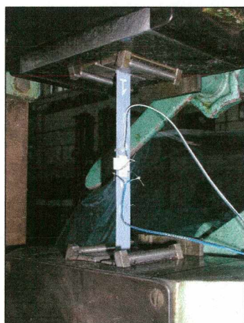
a) próbka w szczękach maszyny
