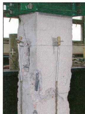
Rys. 4.23. Obraz zniszczenia elementu kontrolnego w etapie IIa
