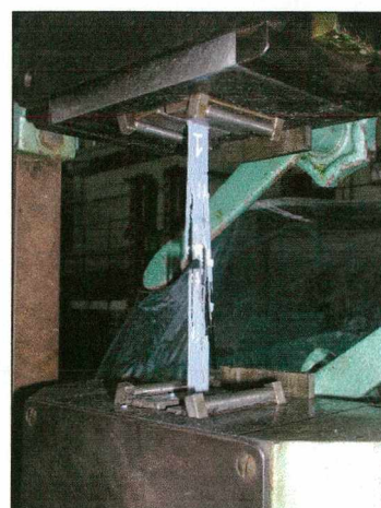
b) próbka po zniszczeniu
