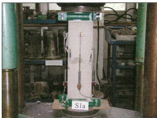
Rys. 4.23. Obraz zniszczenia elementu kontrolnego w etapie IIa
