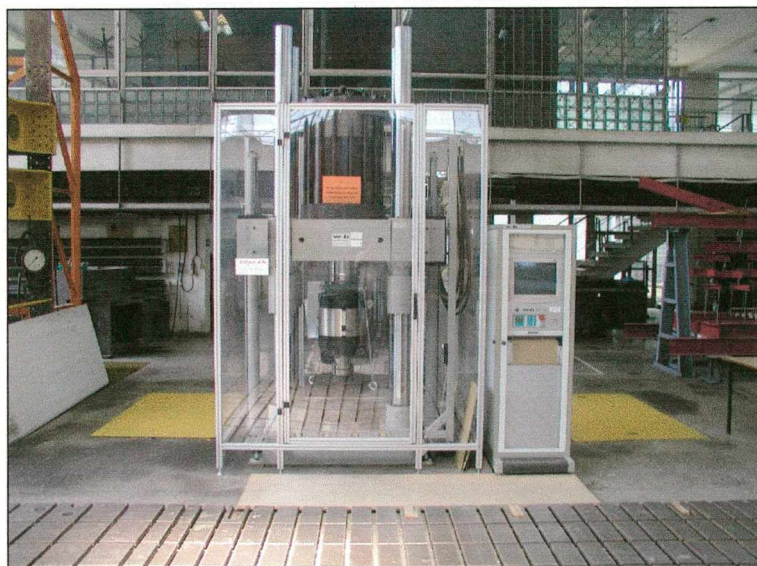
Rys. 4.58. Maszyna wytrzymałościowa WALTER+BAI
