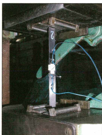
a) próbka w szczękach maszyny
