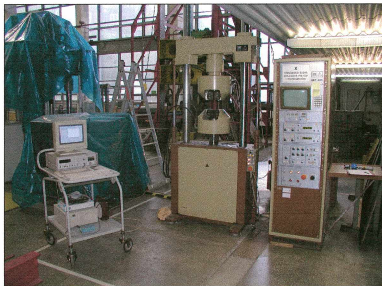
Rys. 4.14. Maszyna wytrzymałościowa UFP 400 oraz aparatura pomiarowo-rejestrująca wyniki
