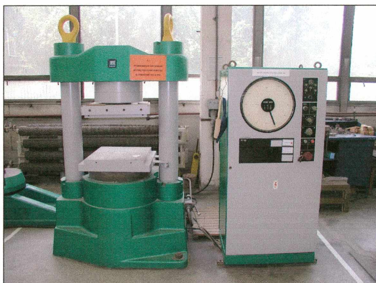
Rys. 4.13. Maszyna wytrzymałościowa EDB 400
