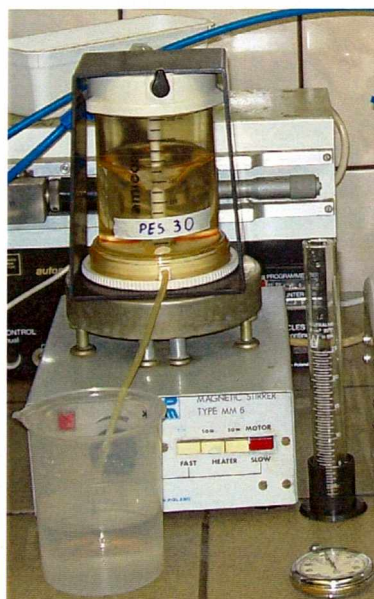
Rysunek 34. Komora Amicon 8400 wraz z mieszadłem magnetycznym
