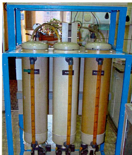
Rysunek 39. Instalacja elektrodialityczna Goemasep 136
