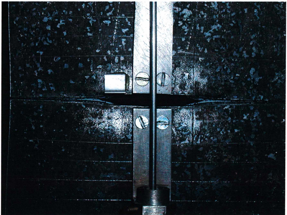
Fot. 5.3-7. Próbką CCT obciążona siłą 314 \text{ kN} . Szczelina zwiększyła swoją długość o około 20 \text{ mm}
