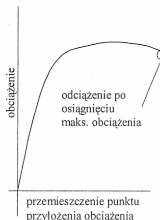
Rys. 2.3.2-3. Schematyczne wykresy siła-przemieszczenie ilustrujące sposoby zachowania się pęknięcia
