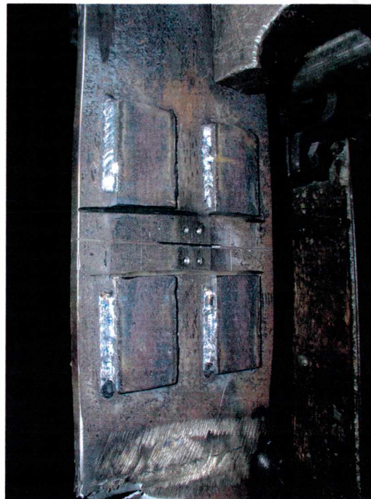
Fot. 5.5.2-3. i 5.5.2-4. Próbką Stal40Sp50 po zniszczeniu (540 kN). Odcięto płaskowniki, aby pokazać szczelinę. Wzrost rozwarcia szczeliny jest bardzo mały
