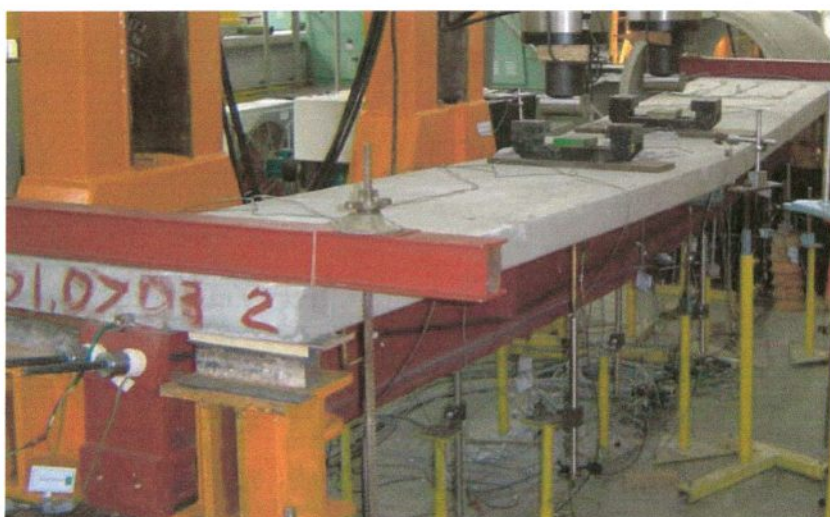
Rys. 6.50. Belka po zniszczeniu
