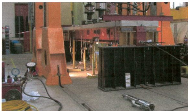
Rys. 6.57. Belka B6 na stanowisku i sprzęt do sprężania
