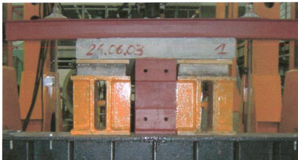
Rys. 6.6. Widelkowe podparcie belki
