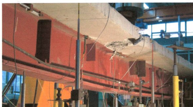
Rys. 6.55. Zniszczenie belki – widok z lewej strony belki
