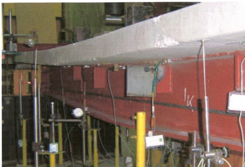
Rys. 6.40. Mechanizm zniszczenia – widok z prawej strony belki
