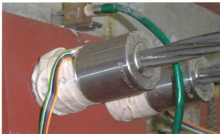
Rys. 6.18. Siłomierze tensometryczne i czujnik poślizgu na końcu belki
