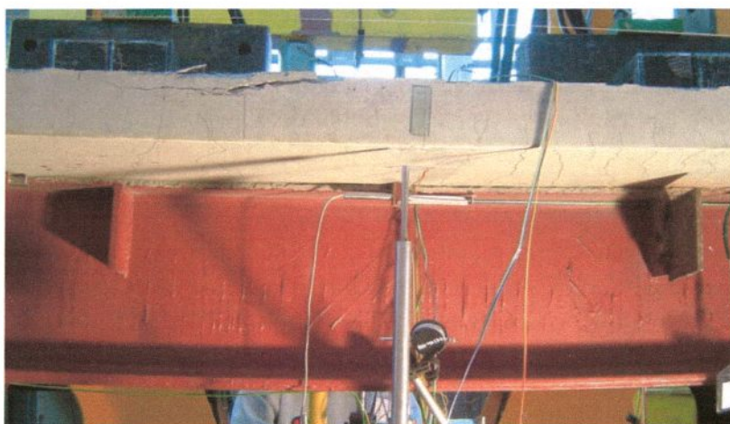
Rys. 6.30. Przesło belki po zniszczeniu – widok od spodu
