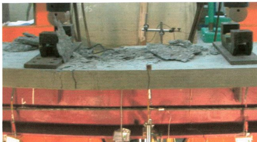
Rys. 6.59. Mechanizm zniszczenia – widok z prawej strony belki
