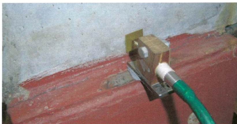
Rys. 6.27. Rysa w zespoleniu na końcu belki
