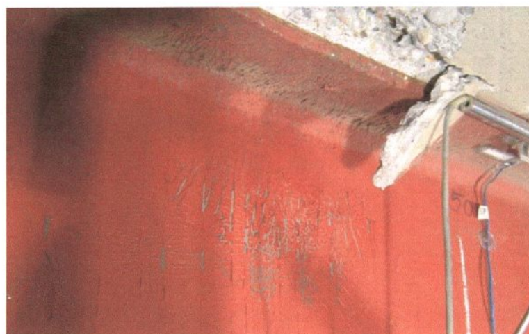
Rys. 6.56. Wyboczenie środnika i pasa górnego
