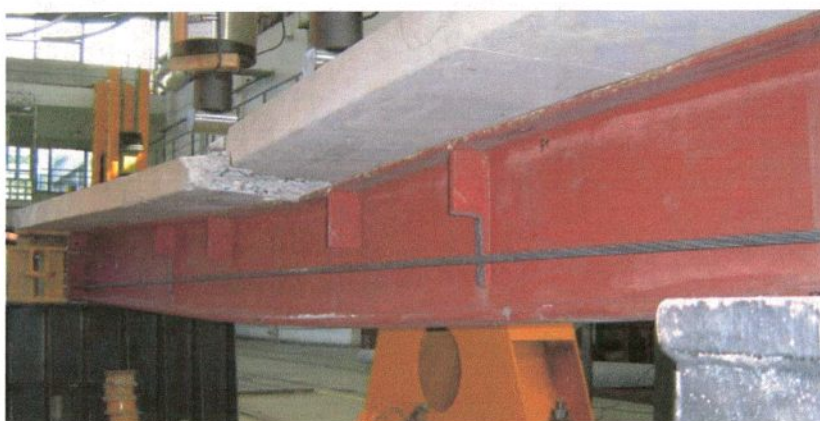
Rys. 6.41. Mechanizm zniszczenia – widok z lewej strony belki
