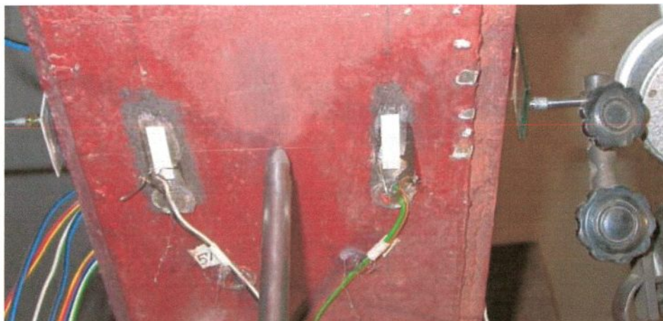
Rys. 6.16. Czujniki na pasie dolnym belki stalowej (tensometry, czujnik indukcyjny i zegarowy)
