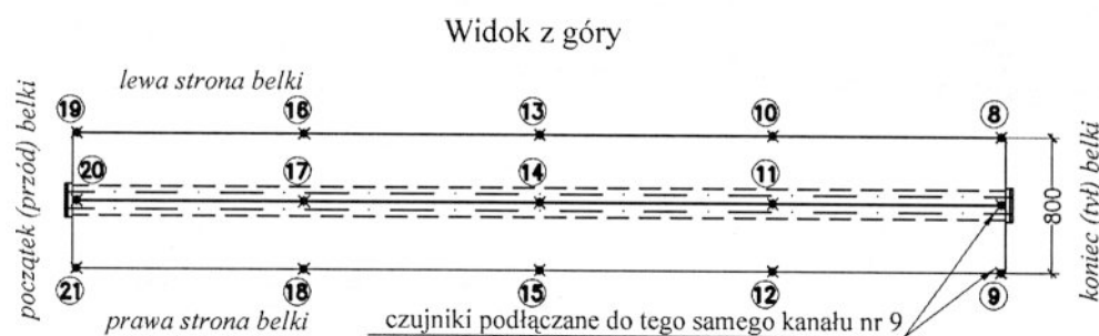
Rys. 6.8. Układ i numeracja czujników indukcyjnych przemieszczeń pionowych
