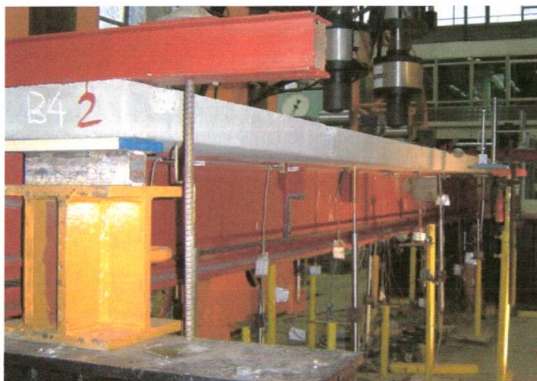
Rys. 6.38. Belka B4 na stanowisku podczas badań
