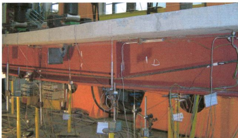
Rys. 6.49. Belka B5 podczas badań pod obciążeniem
