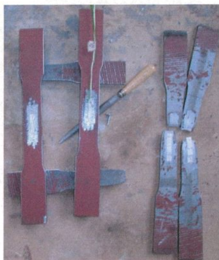
Rys. 5.1. Próbki stalowe przed i po zniszczeniu oraz uzyskany wykres \sigma - \epsilon
