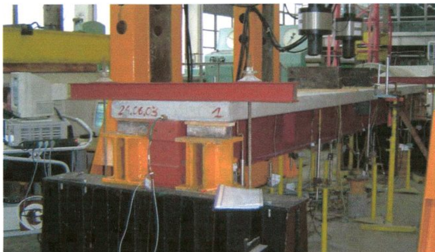
Rys. 6.25. Belka B2 na stanowisku
