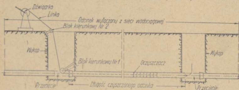
Rys. 1. Schemat usuwania osadu z przewodów wodociągowych oczyszczaczem metalowym.
