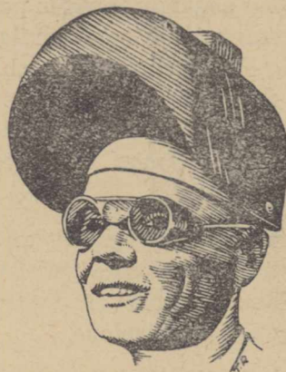
Rys. Nr 2. Dodatkowe okulary ze szklami przyciemnionymi dla ochrony przed promieniowaniem ze stanowisk sąsiednich, gdy przyłbica jest podniesiona.
