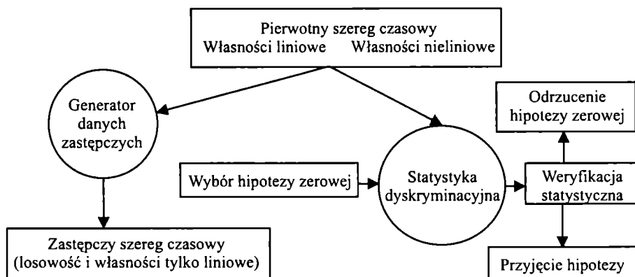
Rys. 1. Schemat procedury badania nieliniowości szeregów czasowych z wykorzystaniem analizy danych zastępczych
