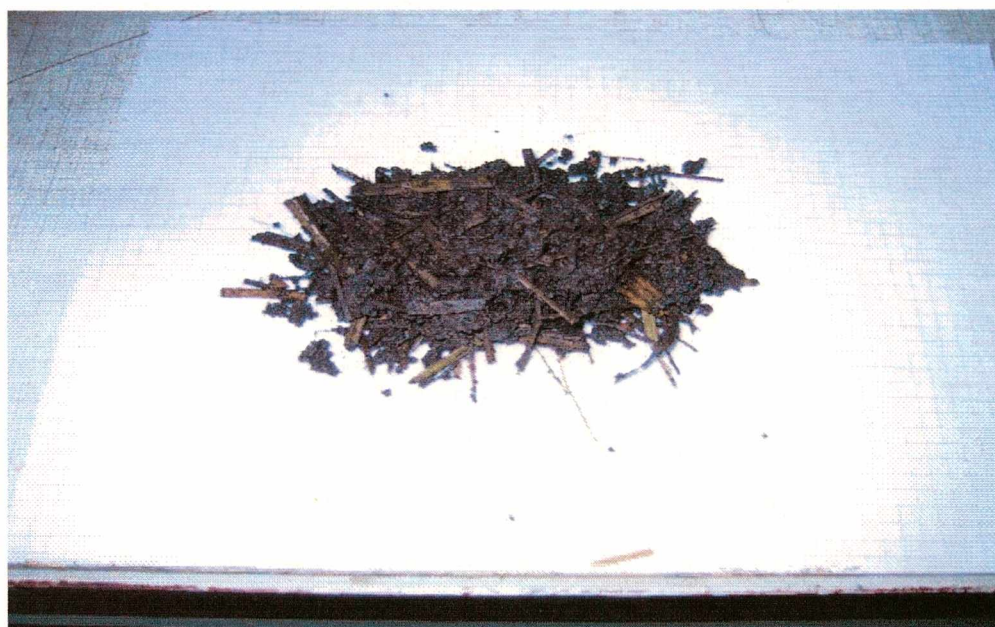
Rysunek 3.6. Złożo biofiltracyjne spulchnione przy pomocy zrąbków drewna.
