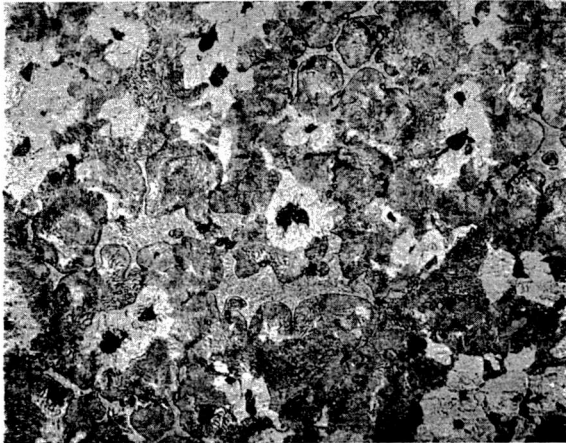
Rys. 9. Eutektyka fosforowa w żeliwie sferoidalnym o podwyższonej zawartości fosforu, traw. azotalem, pow. 100×
