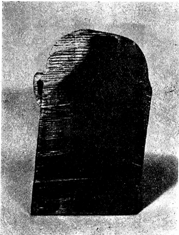
Rys. 14. Nadlew ciśnieniowy (nabój w osłonie z masy formierskiej)
