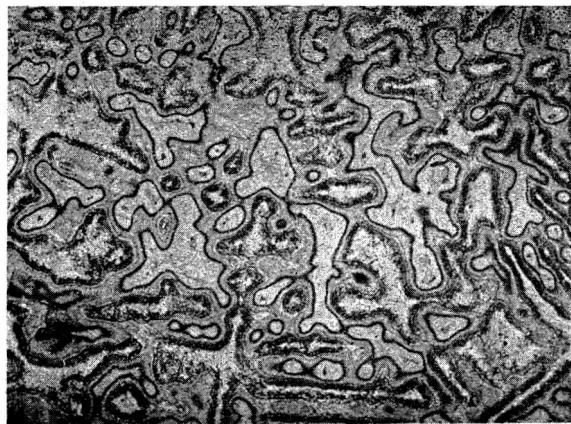
Rys. 11. Mikrostruktura stopu CuSn4Zn3; powiększenie 100 X, trawiono elektrolitycznie
