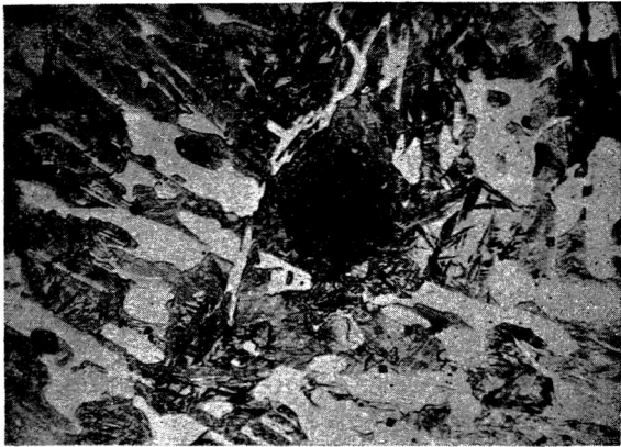
Rys. 5. Struktura osnowy próbki nr 4 (martenzyt + cementyt) traw, azotol, pow. 500 X.
