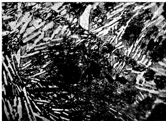
Rys. 12. Grafit sferoidalny w próbce nr 4 (jak wyżej) w osnowie martenzytycznej, traw. azotol, pow. 500 X.
