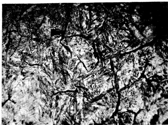
Rys. 10. Grafit o międzydendrytycznym rozłożeniu w próbce nr 3 — (jak wyżej) w osnowie martenzytycznej traw. azotol pow. 500 X.
