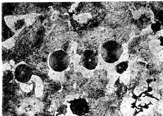
Rys. 10. Struktura żeliwa sferoidalnego, uzyskanego przez dodatek stopu MSF-20, traw. azot., pow. 500 ×
