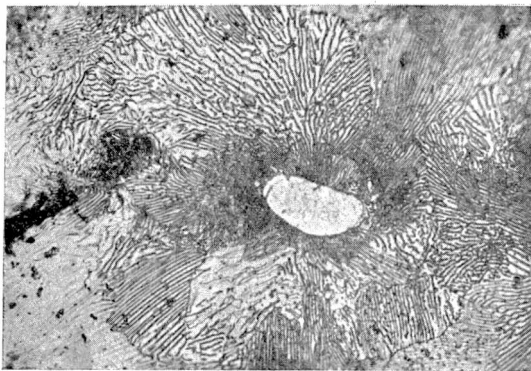
Rys. 9. — Żeliwo szare polerowane i trawione elektrolitycznie — pow. 500 x
