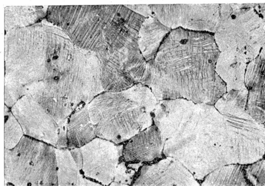
Rys. 7. — Stal Hatfielda polerowana i trawiona elektrolitycznie — pow. 100 x
