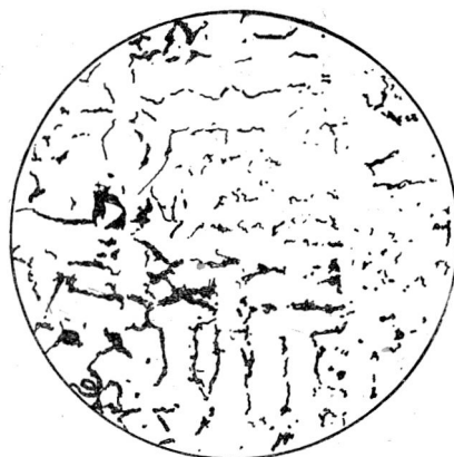
Rys. 2 — „Grafit przechłodzenia“ (x 100).
