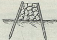
Abb. 78 a und b. Buhnen aus Steinschüttung zwischen Pfahlreihen.
