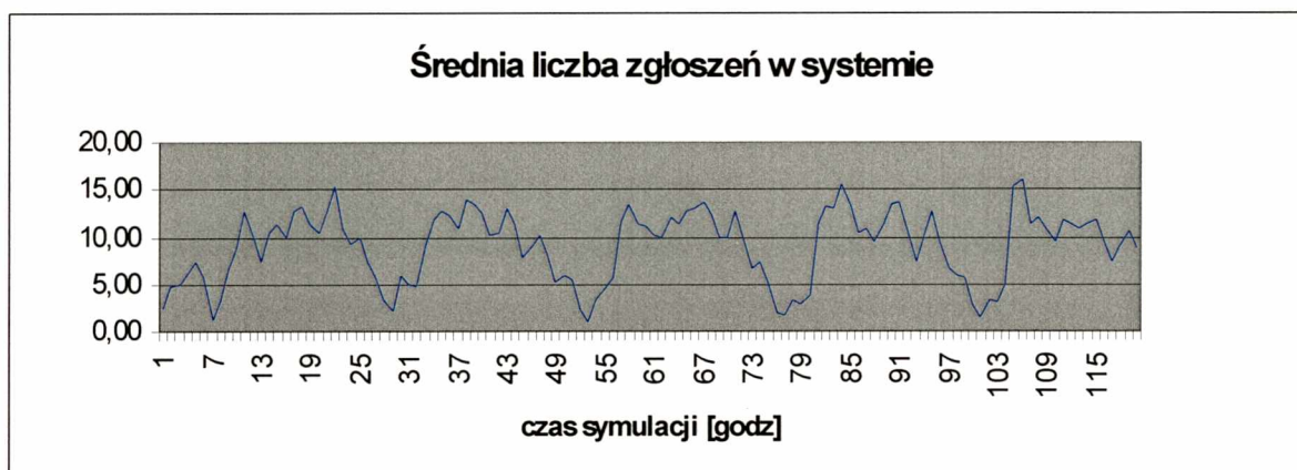
Rys.4.15. Analiza wpływu warunków początkowych – średnia liczba zgłoszeń jednocześnie przebywających w systemie w poszczególnych godzinach. Wyniki uśrednione dla 5 powtórzeń.
