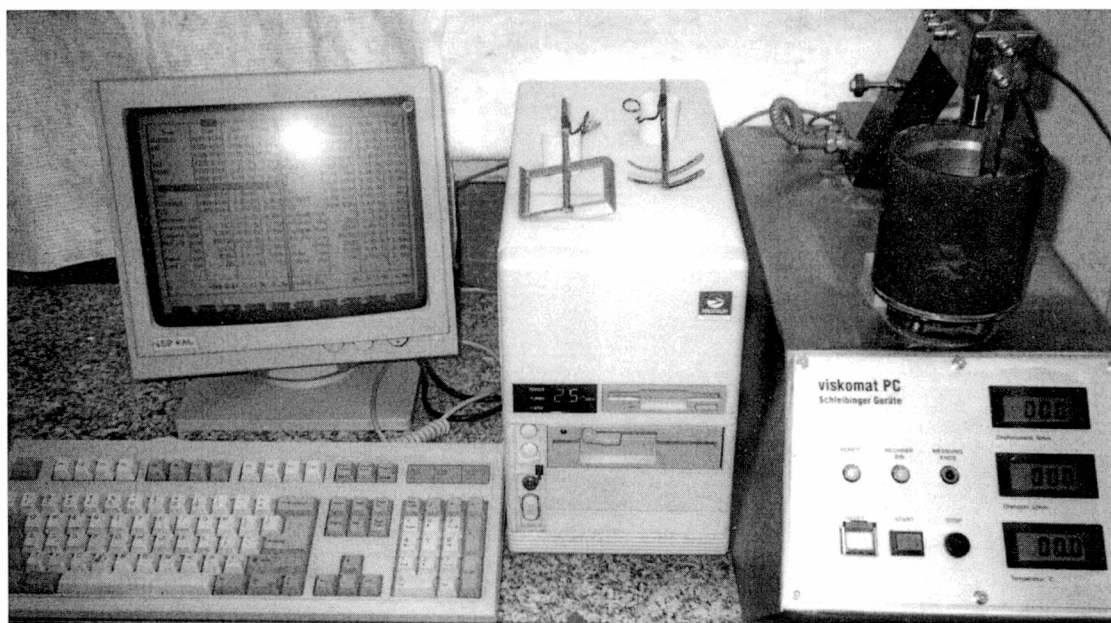
Rys.3.5 Stanowisko badawcze do pomiaru parametrów reologicznych g i h
