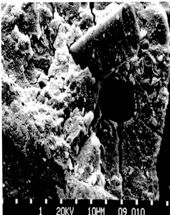
Rys.4.43 Przełomy po próbach zginania kompozytów typu: a) zaczynów, b) zapraw, uzbrojonych niskomodulowymi włóknami węglowymi
