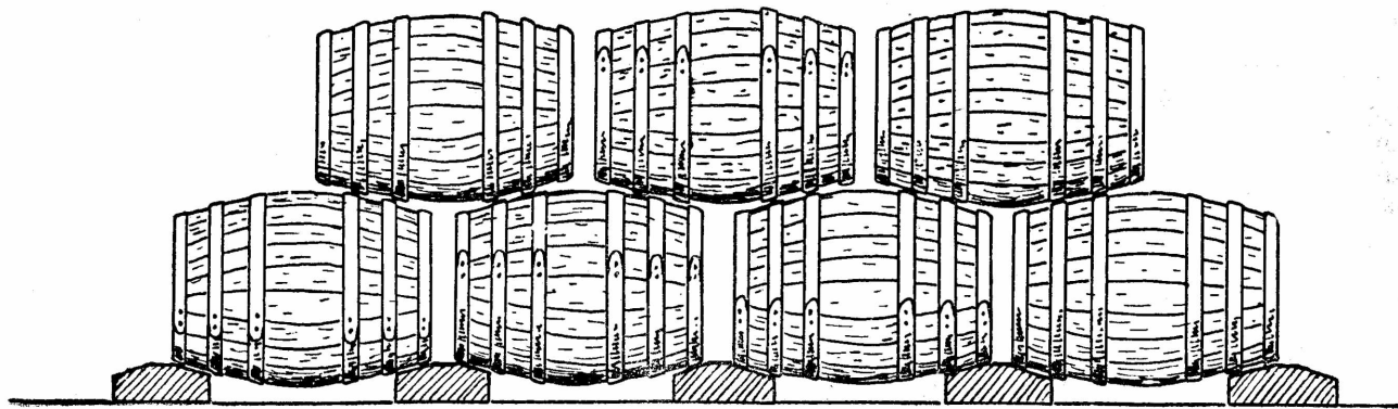
Rys. 2. Układanie beczek rzędami na legarach
