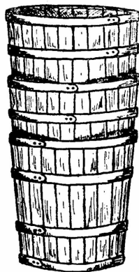
Rys. 3. Układanie beczek o kształcie odwróconego stożka ściętego (kadek bez wieka)
