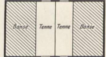
Abb. 191. Scheune mit doppelter Quertenne.
