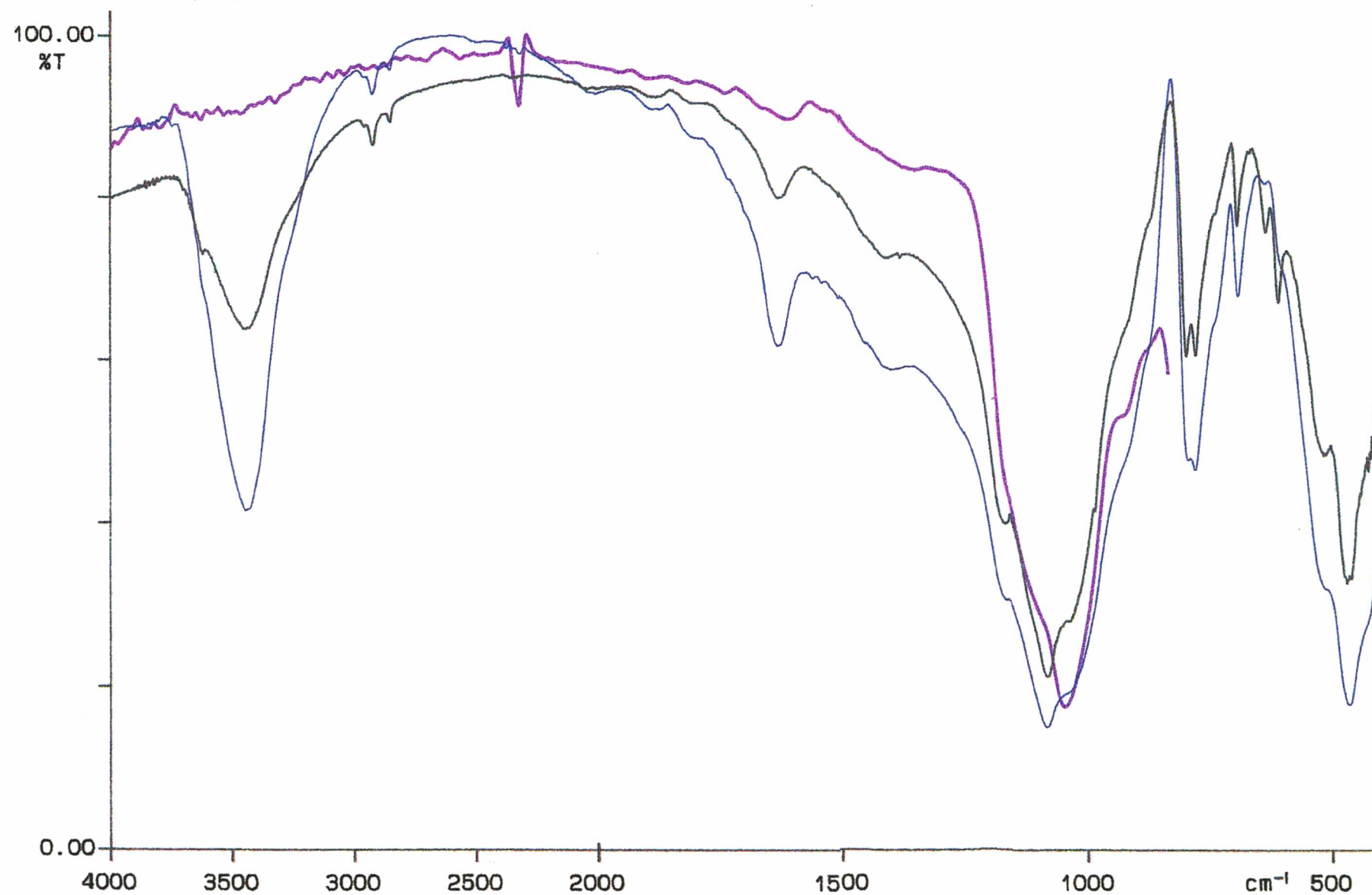
Rysunek 12. Widmo absorpcyjne oraz objętościowe (ATR) w podczerwieni wtórnych odpadów barytowo - fluorytowych
