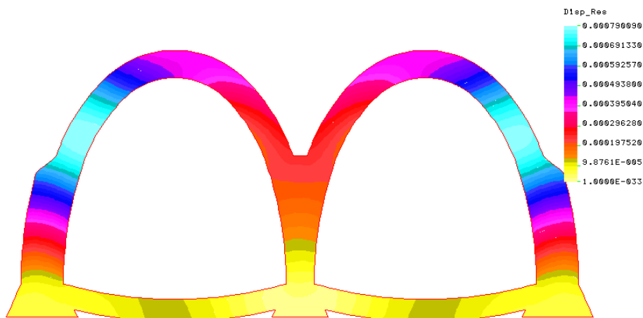
Rys. 3.42. Wykres przemieszczeń sumarycznych; maksymalne przemieszczenie 0,8 mm
