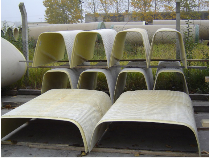
Rys. 3.10. Moduły z GRP (system TexTec) do rewaloryzacji konstrukcji kanałów o przekrojach prostokątnych
