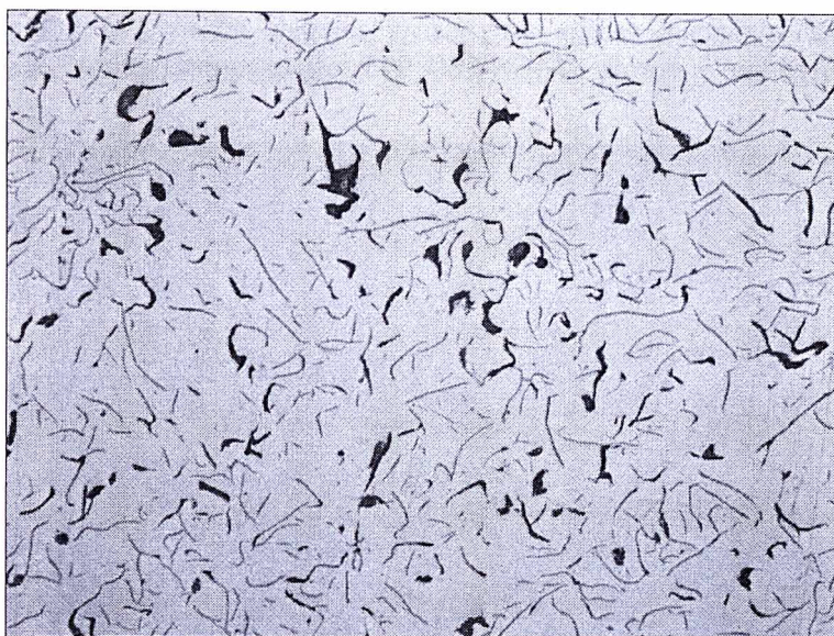
Rys. 3.29. Zdjęcie ukazujące wydzielenia grafitu. Powiększenie 100×
