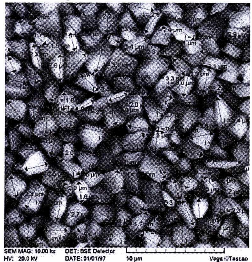
Rys. 3.28. Widok krystalitów diamentu [materiał własny FPT Prima S.A.]
