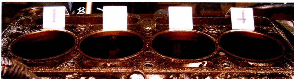
Rys. 6.40. Widok bloku silnika po próbie po demontażu tłoków i zdjęciu nagaru
