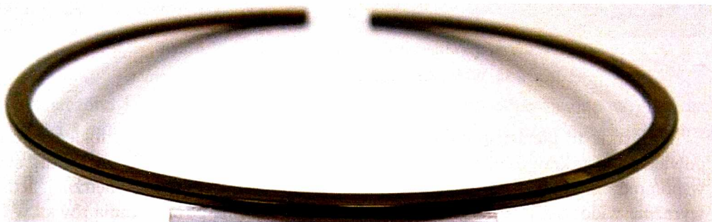
Rys. 6.32. Powierzchnia boczna pierwszego pierścienia uszczelniającego cylindra nr 3
