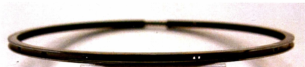
Rys. 6.38. Widok olejowego pierścienia cylindra nr 2 (chromowany)
