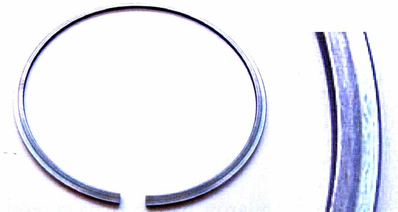
Rys. 6.16. Widok dolnej powierzchni pierwszego pierścienia uszczelniającego cylindra nr 4; po prawej stronie powiększony fragment pierścienia
