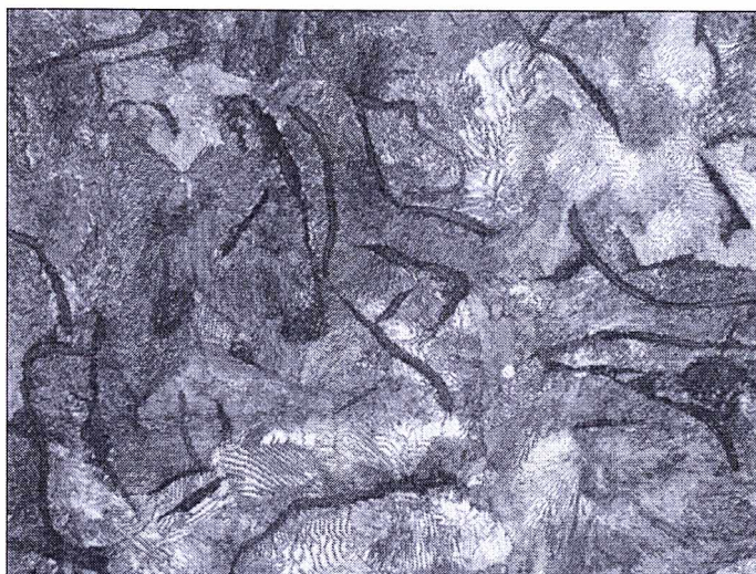
Rys. 3.33. Próbką z widoczną ośnową perlityczną. Powiększenie 400×
