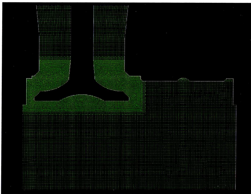
Rys. 4.15. Model dyskretny dolotu ładunku do cylindra
