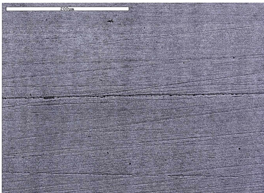
Rys. 3.10. Część środkowa powierzchni taśmy. Mikroskopia skaningowa BSE
