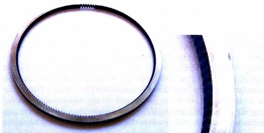
Rys. 6.21. Widok górnej powierzchni olejowego pierścienia cylindra nr 1; po prawej powiększony fragment pierścienia
