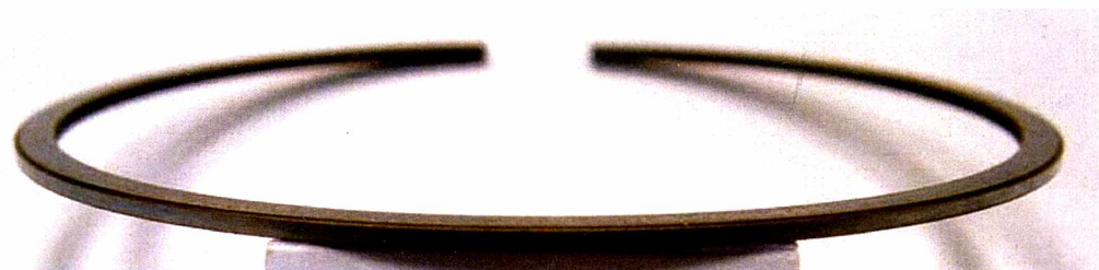
Rys. 6.33. Powierzchnia boczna pierwszego pierścienia uszczelniającego cylindra nr 4
