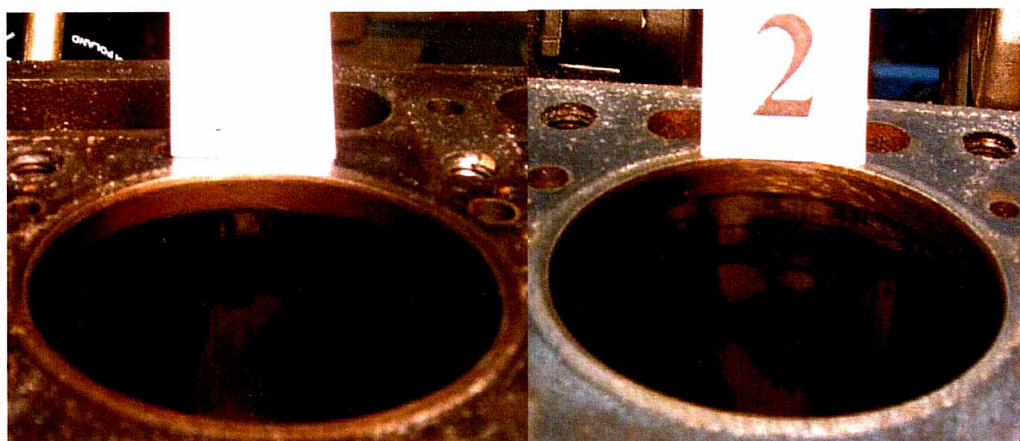
Rys. 6.42. Widok cylindra nr 2 po próbie; po lewej strona oddziaływania maksymalnej siły normalnej, po prawej strona przeciwna
