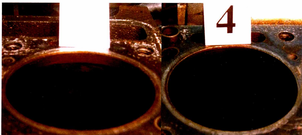
Rys. 6.44. Widok cylindra nr 4 po próbie; po lewej strona oddziaływania maksymalnej siły normalnej, po prawej strona przeciwna
