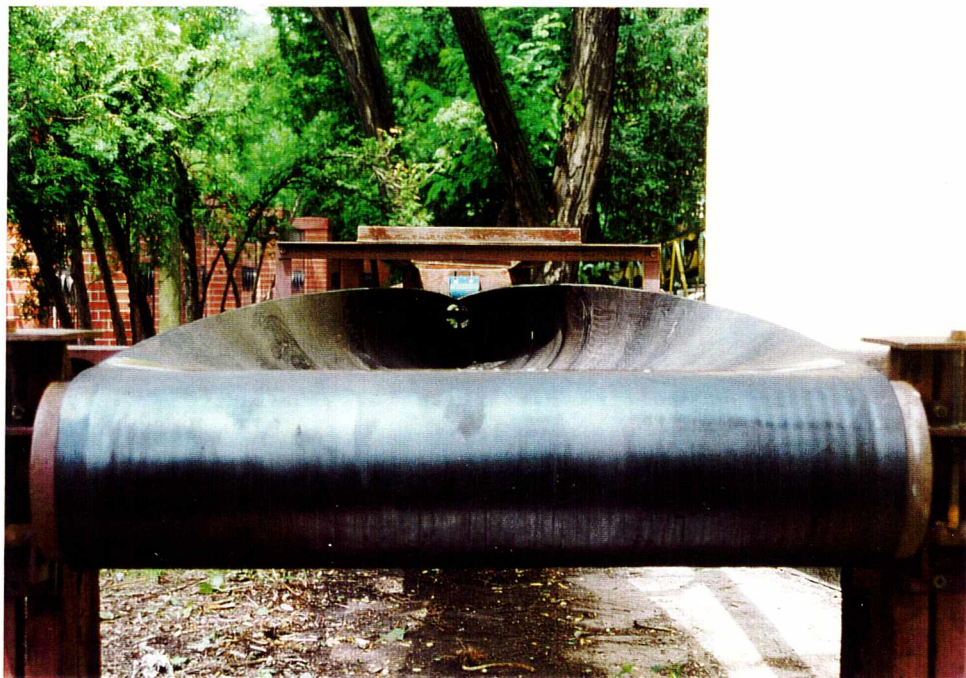
Fotografia 1-3. Stanowisko pomiarowe odcinka przejściowego przenośnika rurowego
