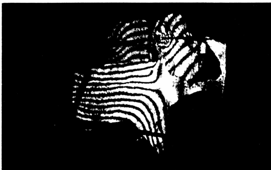
Rys. 5.19. Interferogram kręgu lędźwiowego L5 - obciążenie trzonu, wyrostków: kolczystego oraz stawowego górnego i dolnego odpowiada modelowaniu pozycji stojącej.
