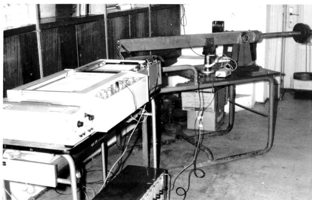
Rys. 17. Widok stanowiska badawczego wraz z próbką do badania rur wg MIII
